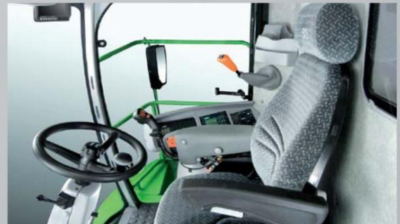
Современная кабина с новой панелью управления и рулевой колонкой, регулируемой в трех плоскостях.
