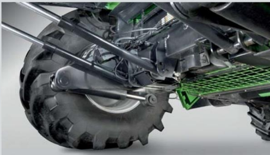
Благодаря системе Balance, комбайны DEUTZ-FAHR сохраняют уровень производительности даже при уборке на наклонной местности.
